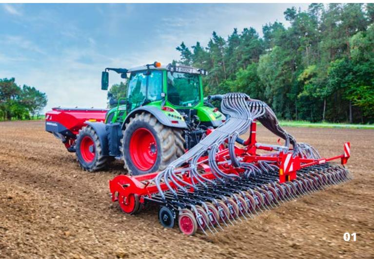
eine gleichmäßige Rückverfestigung und somit gleiche Bedingungen für jedes Säschar. So werden wiederum identische Bedingungen für jedes Korn geschaffen, diese werden präzise abgelegt und ein gleichmäßiger Feldaufgang entsteht.
