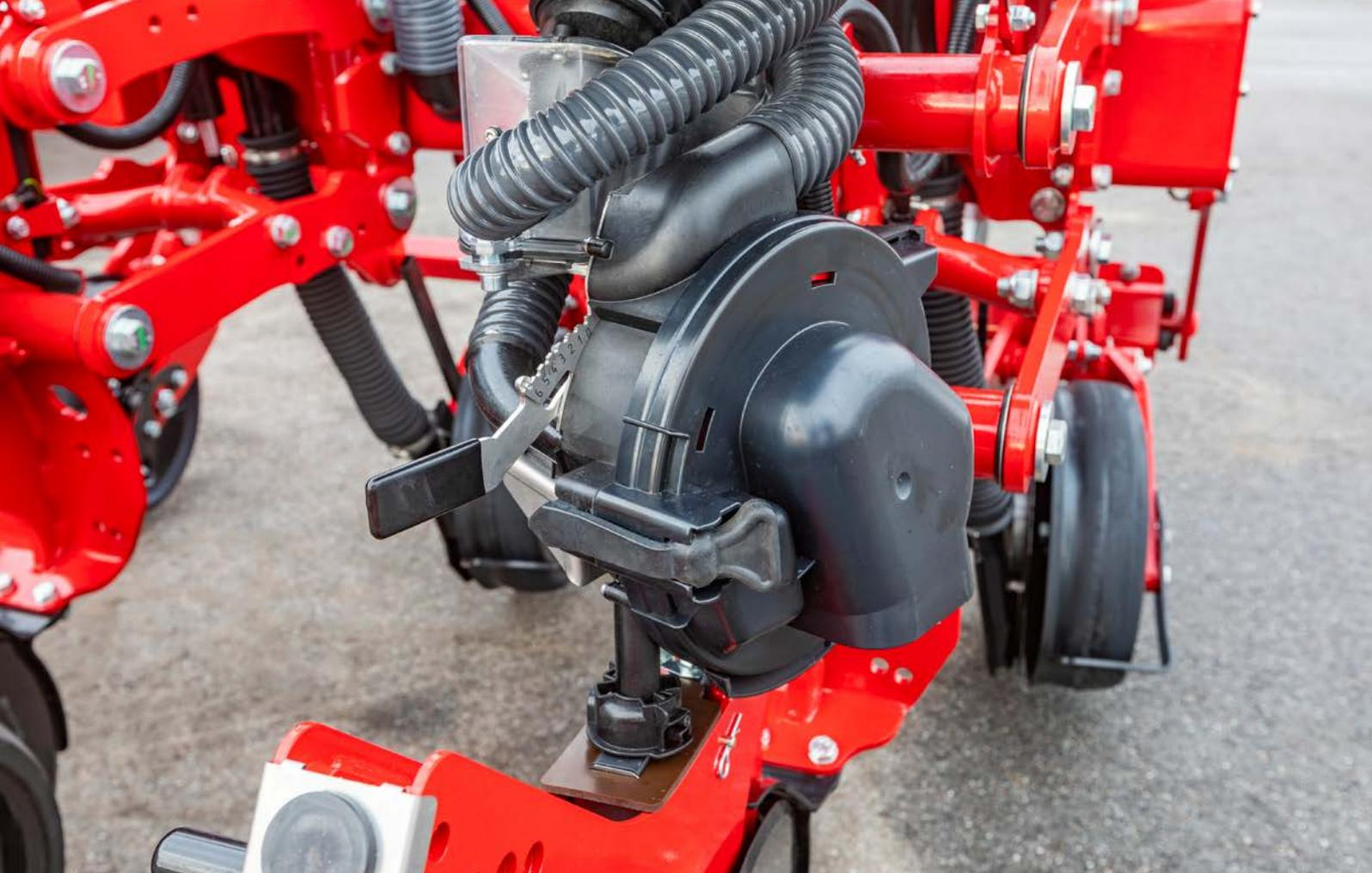
Das AirSpeed System bietet maximale Schlagkraft und eine sichere Korneinbettung durch das Schusssystem und die Fangrolle.
